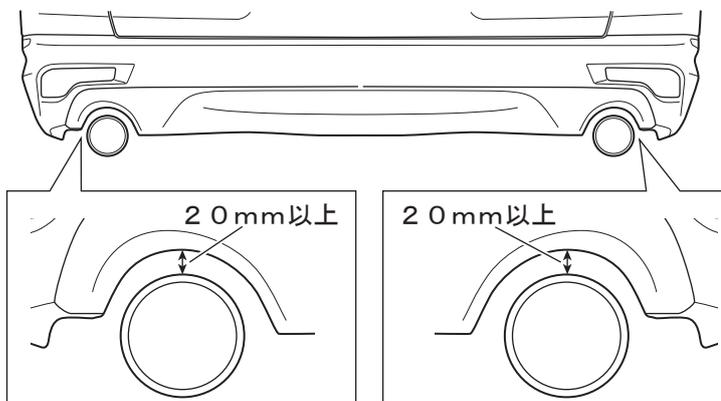
※マフラー出口部を左右均等且つ、リアバンパーとの隙が20mm以上（出口上端部）になるよう調整する。
