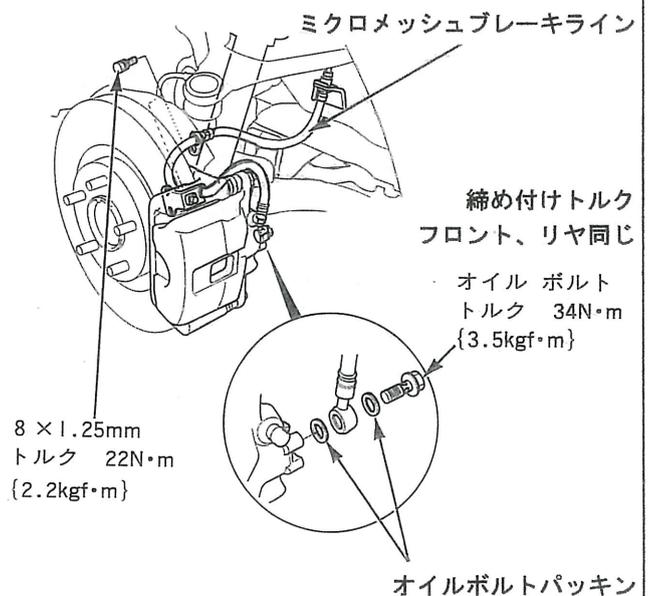
⑦ホース固定クリップをブレーキホースの溝に取り付けて、ホースを固定する。
