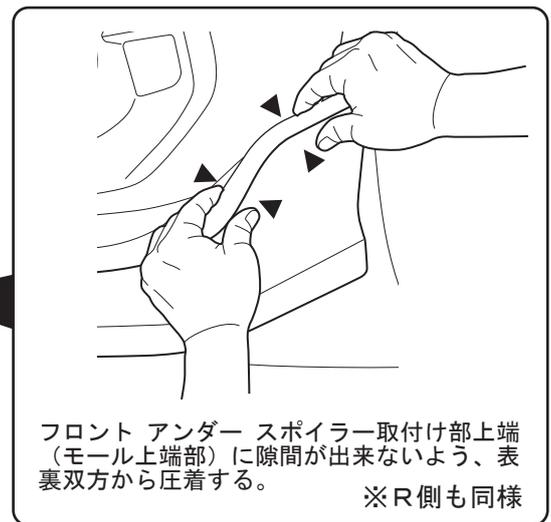
フロント アンダー スポイラー取付け部上端 (モール上端部) に隙間が出来ないように、表裏双方から圧着する。
