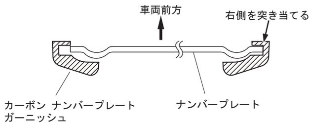
⑥下図のように本製品の左側のフックをナンバープレートに引っ掛けながら、ナンバープレート中央までスライドさせる。
