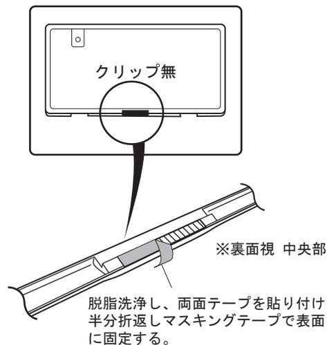
④本製品の取り付けフランジに注意しながら、下図の要領でナンバープレート右側よりスライド挿入させる。
