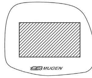
※斜線部分(両面テープ貼付位置)を丁寧に押し付けて確実に圧着して下さい。
