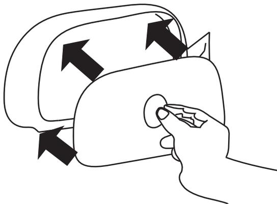
6. 最後にミラーボディと hidroミラーをしっかりと密着させる。(装着後24時間で安定)
