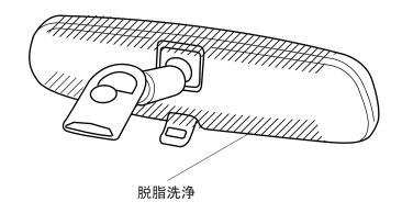
②カーボン ルームミラーカバーの離型紙を剥がし、カーボン ルームミラーカバーを広げながら ルームミラーに被せて、接着部分を指で押して圧着させる。
