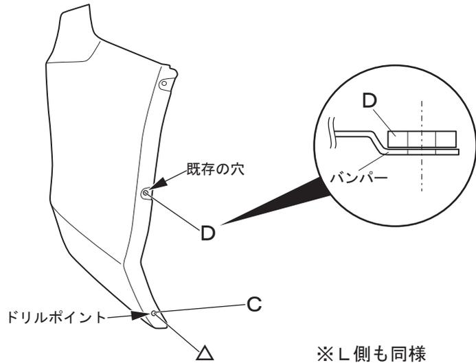
⑥車両にリアバンパーを取り付ける。（サービスマニュアル参照）その際に左右ホイールハウス折返し部のゴムワッシャー（D）を貼り付けた穴は、リアアンダースポイラー装着時に使用するため、純正タッピングスクリューを復元しない。また、リアバンパー下面中央寄り2ヶ所の純正クリップもリアアンダースポイラー装着時に共止めする為、復元しない。
