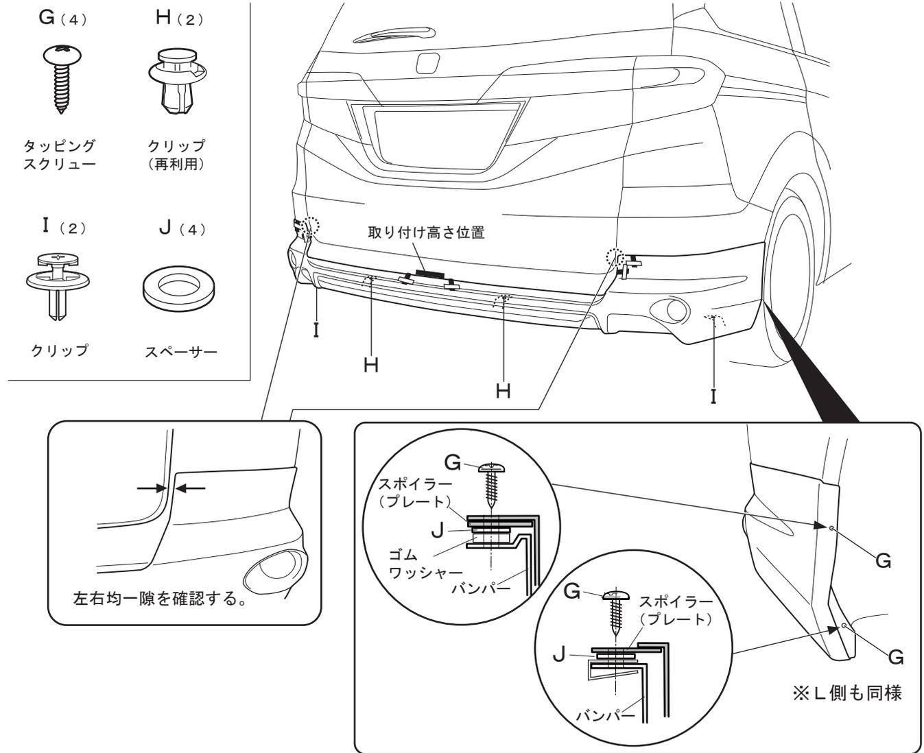
⑥取り付け位置を確認し、両面テープの離型紙を矢印の方向に下記順番で引き抜く様に剥がし圧着する。
