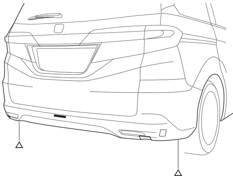
⑤リア アンダー スポイラーを車両にタッピングスクリュー（G）、純正クリップ（H）、クリップ（I）で仮固定する。周長調整する際は、スペーサー（J）を使用する。
